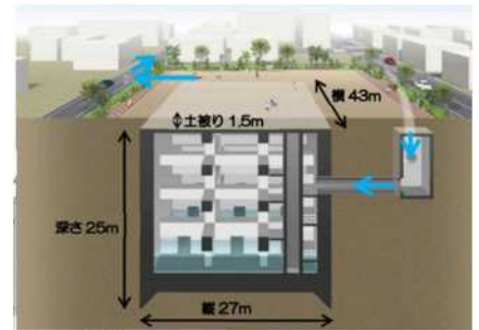
あさひ公園地下貯留槽
