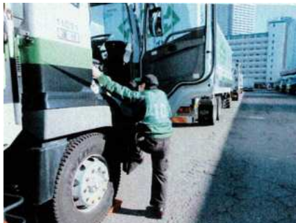
墜落・転落防止：三点支持の徹底
