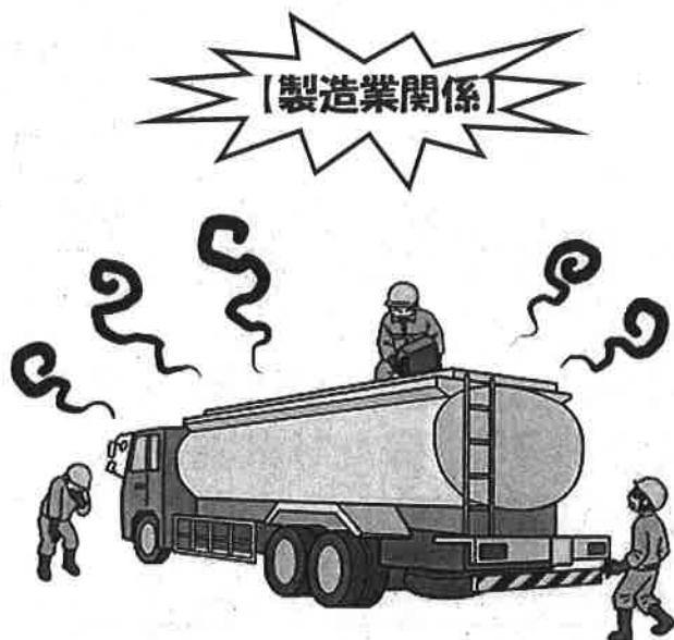
(災害発生状況) 保管されていた内容不明の廃液をタンクローリーで回収し、さらにソフトエッチング廃液（過硫酸ソーダ、硫酸、水）を混合回収していたところ、タンクローリー内で化学反応により発生した有害ガス（塩素ガス）により、付近で作業していた労働者が病院に搬送され、塩素ガス中毒となった労働災害。
